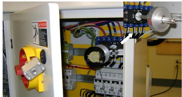
Figure 7. Potentiomètre rotatif intégré au sectionneur de la presse à injection
